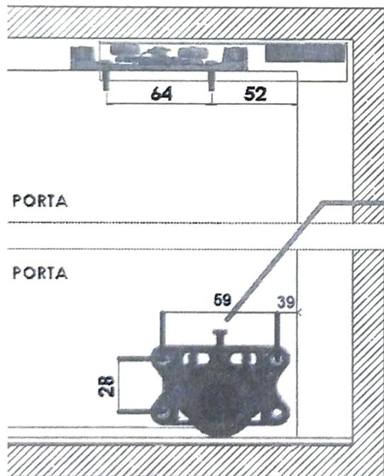
Para acionar a trava do sistema preclone com força a roldana até o final do curso da chapa e segure brevemente.
